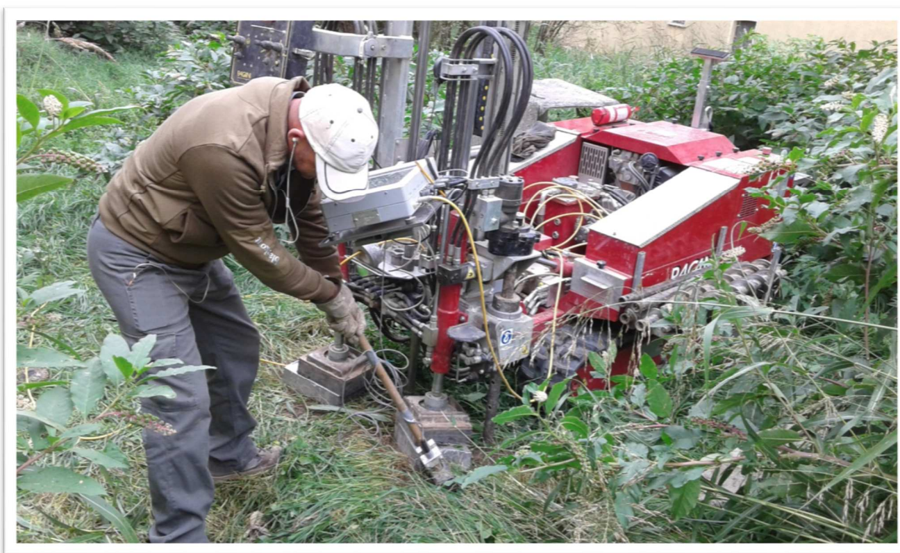
Foto 2 – Particolare della prova penetrometrica SCPTU 1
