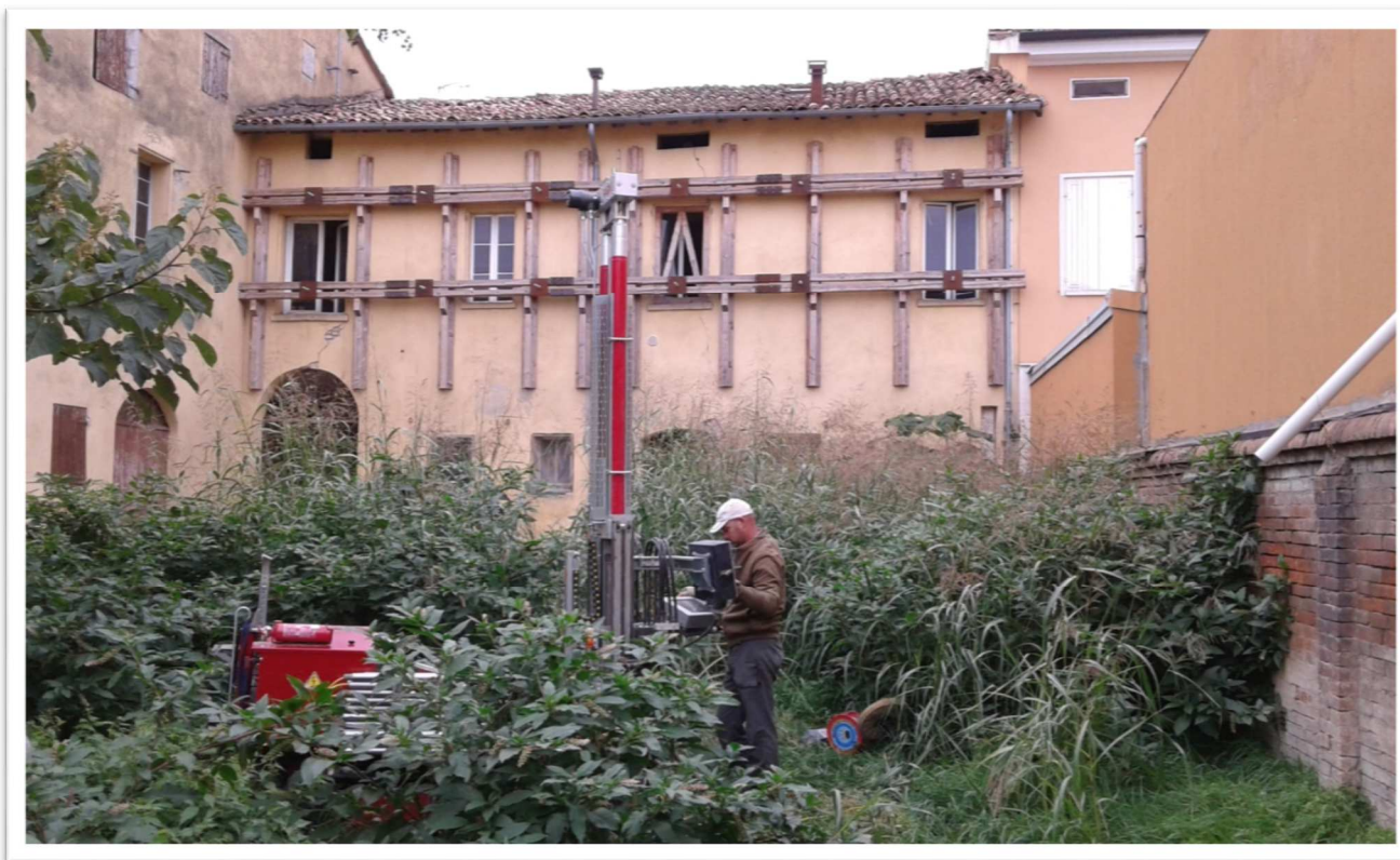
Foto 1 – Prova penetrometrica SCPTU 1
